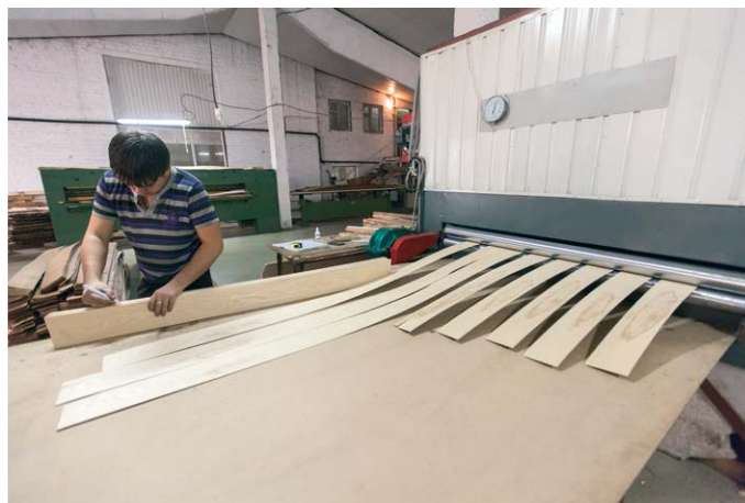
Строгание и сушка шпона на японском оборудовании.
